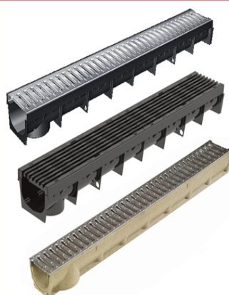
MEA WM Odvodňovací žlaby MEA PARK – ocelový PZ rošt MEA PARK – černý PP rošt SELF LINE – polymerbeton, PZ rošt Délka 1m, třída A15
